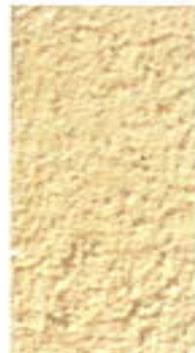
**l'enduit à la chaux** protège la maçonnerie et se colore facilement au moyen de sable teinté ou d'ocres naturels.
